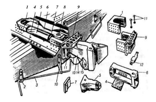
1 - задний упор, 2 - кронштейн, 3 - двуплечий рычаг, 4 - поддерживающая планка, 5 - поглощающий аппарат, 6 - тяговый хомут, 7 - упорная плита, 8 - клин, 9 - ударная розетка, 10 - державка, 11 - маятниковые подвески, 12 - центрирующая балочка, 13 - корпус автосцепки, 14 - цепь, 15 - валик подъемника
