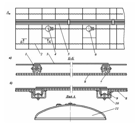
Рисунок 1.6 – Крыша кузова
