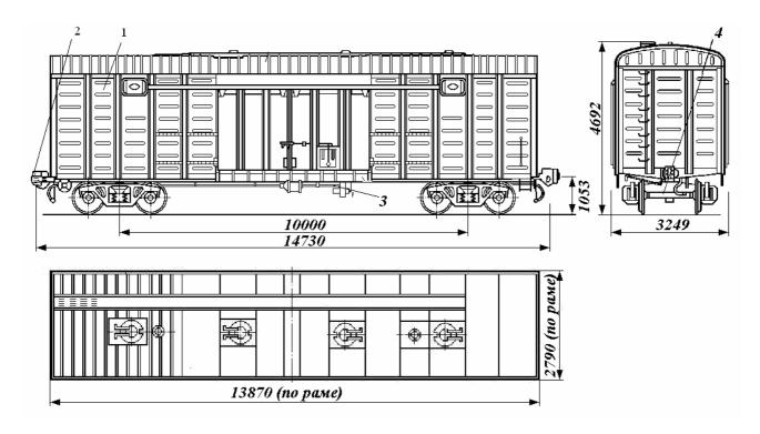
Рисунок 1.1 – Конструкция крытого вагона
