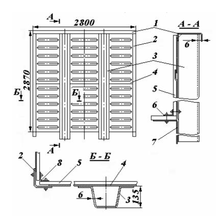
Рисунок 1.5 - Торцевая стена кузова
