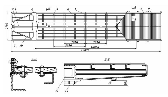
Рисунок 1.2 - Рама кузова крытого вагона
