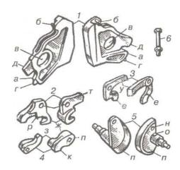
1 - замок, 2 - замкодержатель, 3 — предохранитель, 4 — подъемник,5 — валик подъемника, 6 — болт
