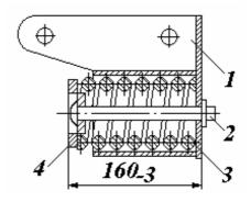
Рисунок 1.4 - Амортизатор
