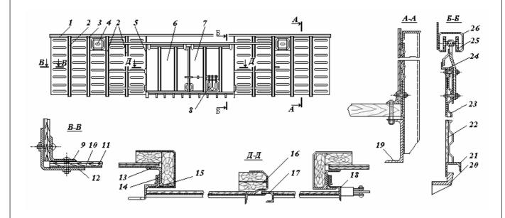
Рисунок 1.3 - Боковая стена грузового вагона
