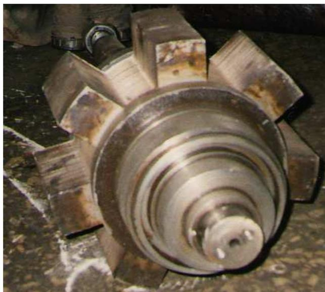
Рисунок 1.3 - Ротор генератора 2ГВ.008
