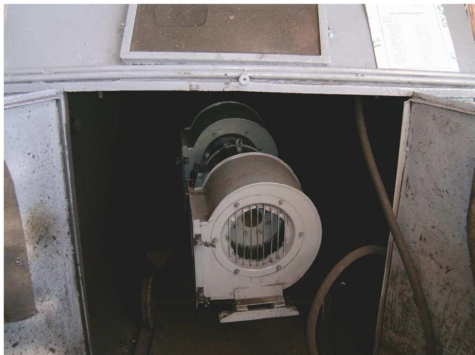
Рисунок 1.5 – Обдувочная камера
